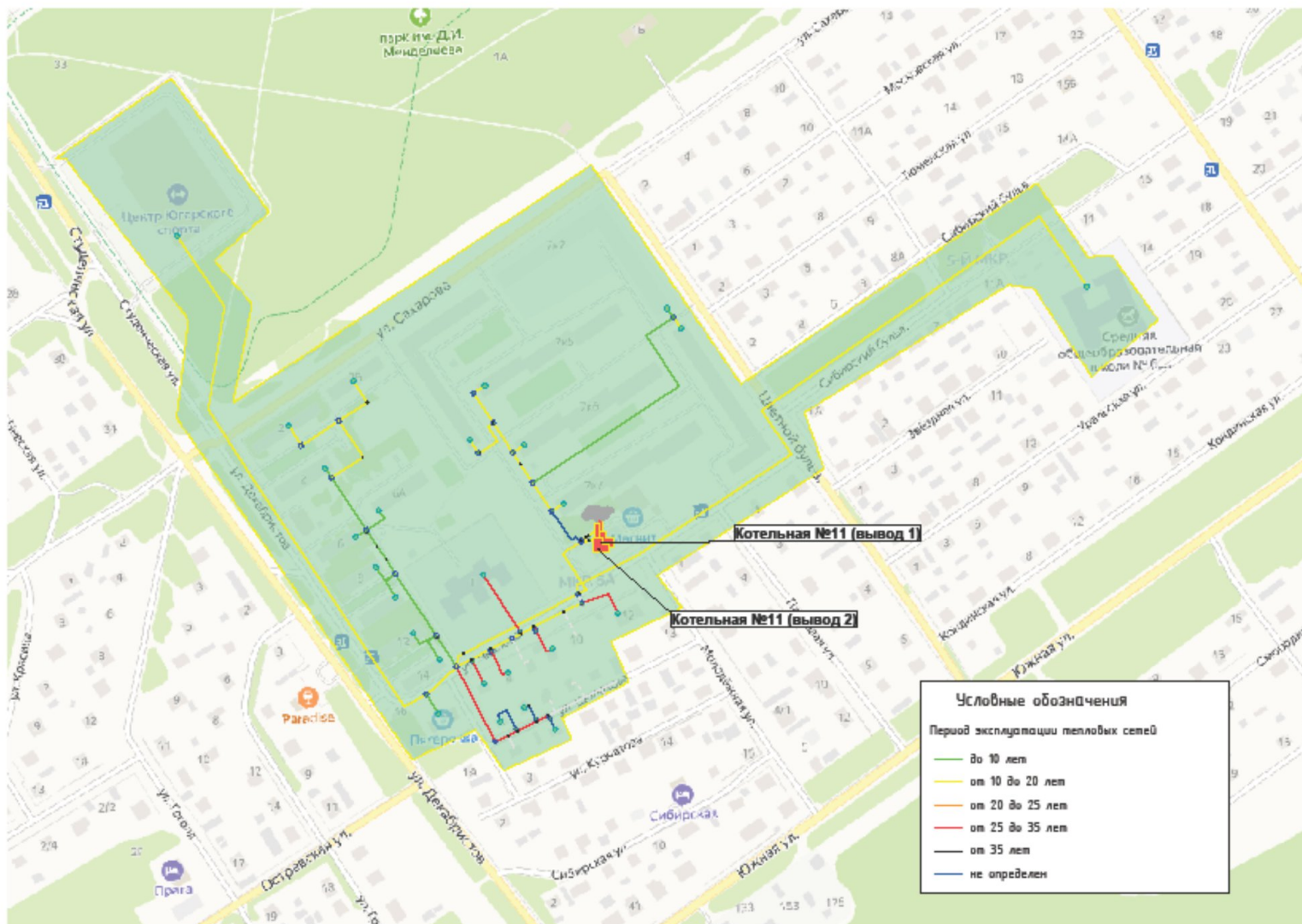
Рисунок 78. Схема тепловых сетей в зоне действия котельной № 11
